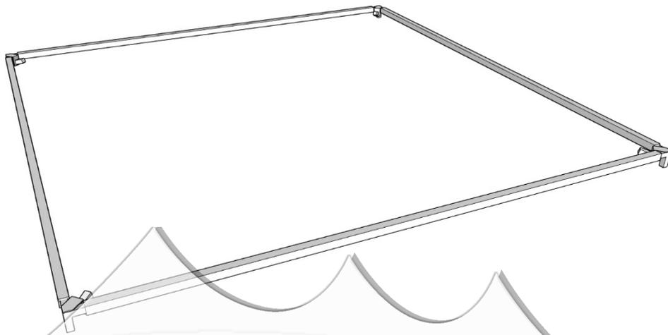
Поставить распорки (стропила) из профильной трубы 35x35 мм и соединить их с центральным фитингом с натяжителем. Винт натяжителя опустить максимально вниз.
